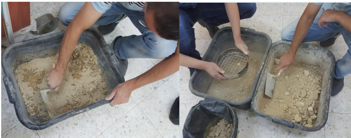
الصورة (2-4) اثناء القيام بتجربة الكثافة العظمى
