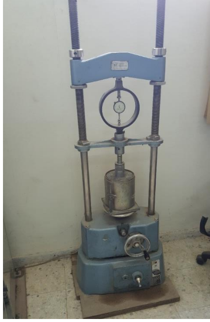
الشكل (3-4) جهاز فحص CBR .
